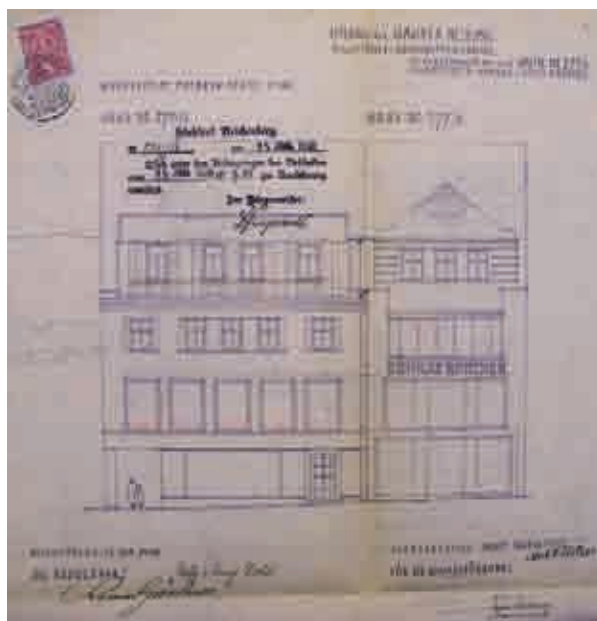
Obr. 9. Ferdinand Elstner, projekt společných stavebních úprav domu č. p. 278 a domu č. p. 277, pohled na fasády směrem do náměstí, datováno 12. ledna 1938. Stavební archiv města Liberce, složka domu čp. 277 (foto P. Šternová).
